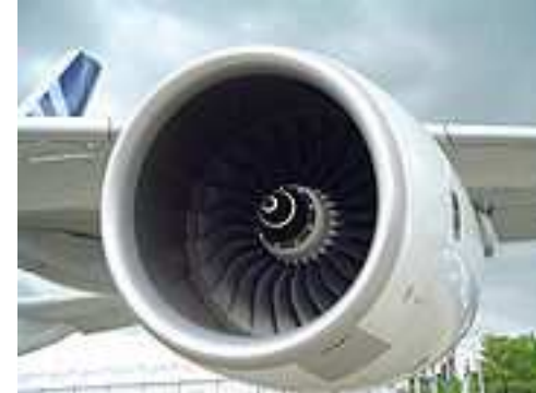
Entrée d'air et soufflante sur un A380 (Trent 900)
