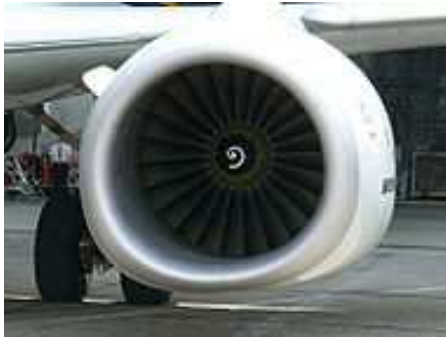
Entrée d'air et soufflante sur un Boeing 737
